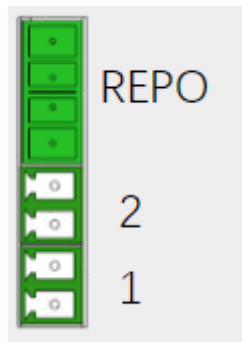
图6-2 干接点接口引脚分布
