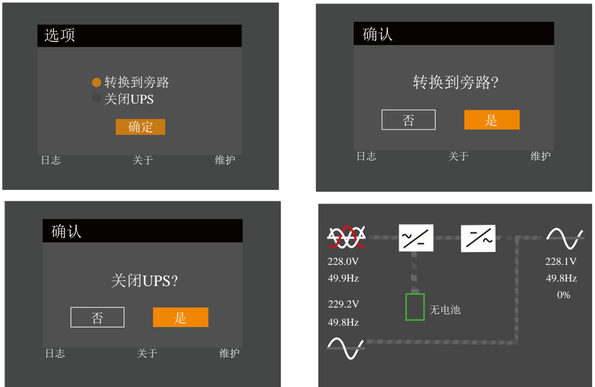
图5-2 旁路正常提示界面
